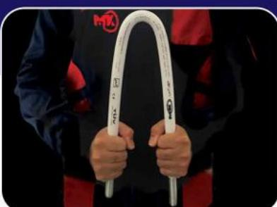
۲- لوله را به آهستگی و با فشاری یکنواخت به گونه ای خم کرده که بافت فوقانی لوله کاملا باز شده و دو طرف لوله به هم رسیده باشد.
